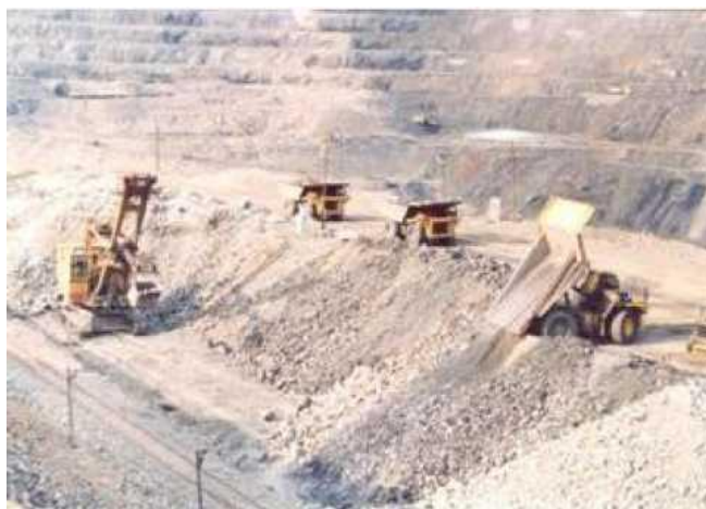
Сурет 14- Солтүстік Қазақстан карьерлеріндегі темір рудасының қайта тиеу-орташа қоймасы
